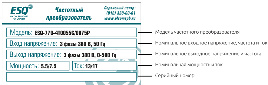
Рисунок 2-4. Изображение шильды частотного преобразователя ESQ-770
