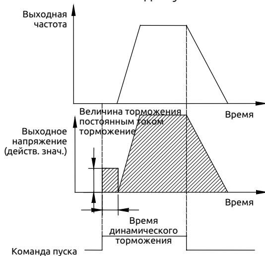
Рис. 7-4 Описание режима пуска 1, заданного кодом F02.06
